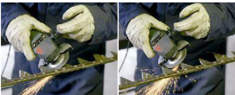
Figuur 4-9: Bij het slijpen met een speciale slijpmachine kun je de hoek exact instellen.
